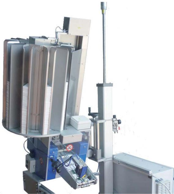
Sfogliatore multimagazzino rotante per libretti istruzione farmaceutici con controllo codice e possibilità di caricamento magazzini a macchina in funzione
