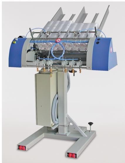
Il sistema è disponibile interamente in acciaio Inox e alluminio anodizzato, con doppio magazzino di carico per vaschette a fondo piatto o alveolari. È movimentato da un motore Brushless e raggiunge una produzione di 160 pz/min a 80 cicli. Progettato per essere integrato sulle confezionatrici Flowpack, o come alimentatore dei nastri trasportatori che convogliano al riempimento manuale.
